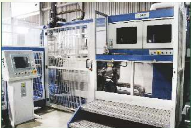
Автоматическая линия вальцовки и сварки (Италия, Швеция)
