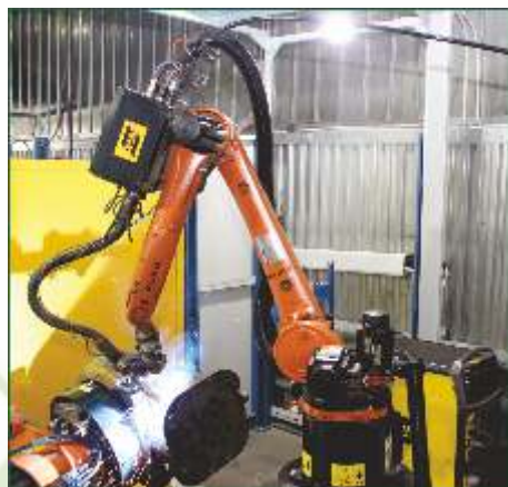
Роботизированный сварочный комплекс на базе робота KUKA (Германия, Швеция)
