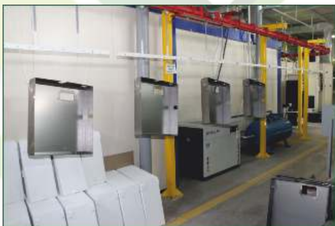
Роботизированная линия порошковой покраски ESTA-OMEGA (Турция)
