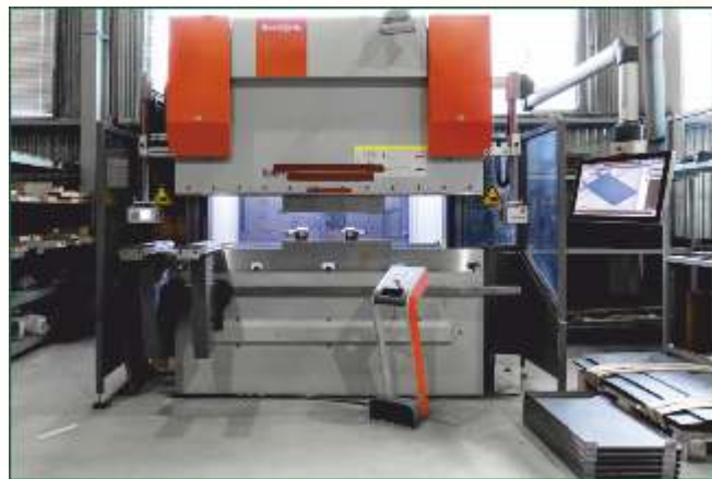
Кромкогибочные прессы Bystronic Xpert (Швейцария)
