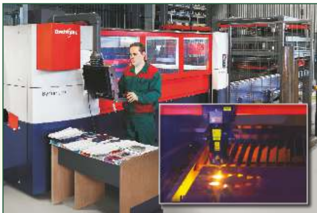
Высокоточная установка лазерной резки с автоматической подачей металла Bystronic Bystar 3015 (Швейцария)
